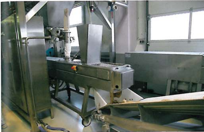
Die Backwelt Pilz nutzt allein den CodosMischer zur Herstellung der Roggenbrotteige, da diese nur eine intensive Mischphase benötigen.
