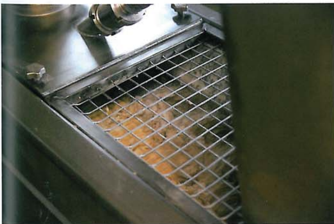
Der Mischer hat die Aufgabe, den trockenen Premix und alle weiteren Teigzutaten (Wasser, Fette usw.) in sehr kurzer Zeit zu einer klumpenfreien Mischung zu verarbeiten.
