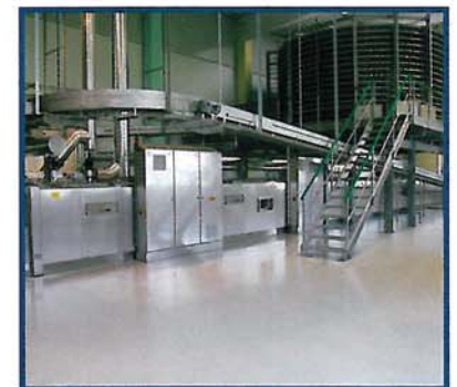
Der Thermoöftunnelofen von Daub. Vor dem Backen können Brote durch ein ausfahrbares Band manuell nachbearbeitet werden.
