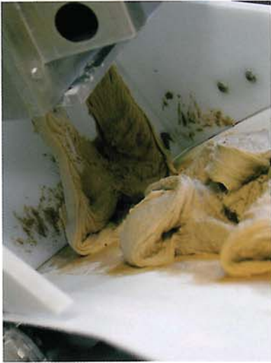
Austrag eines gut gekneteten Roggenteiges. Die restliche Teigentwicklung findet auf dem Teigruheband statt.
