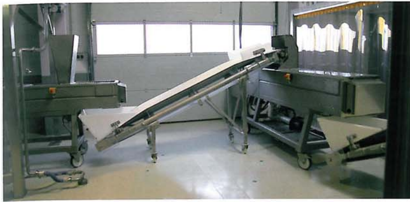
Produktwechsel: Für Weizenteige wird der CodosMischer mit dem Kneiter kombiniert. Rechts im Bild sieht man die Nasszelle zum Reinigen des Systems.
