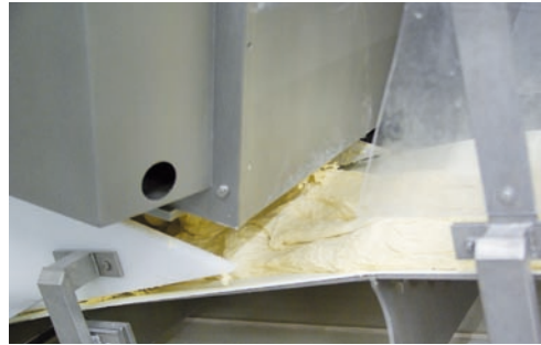
Der Teig verlässt den Mischer und gelangt über ein Förderband in den Knetter. Beim kontinuierlichen System sind die Arbeitsschritte Mischen und Kneten getrennt. Jedes der beiden Anlagenteile verfügt über ein eigenes Werkzeug, das für die jeweilige Aufgabe definiert ist.
