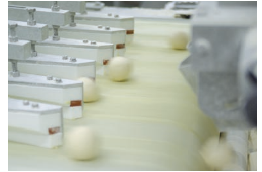
50.000 Buns teilt der Teigteiler pro Stunde. Die Teigstücke werden mittels einer Wirkstrecke in eine gleichmäßig runde Form gebracht.
