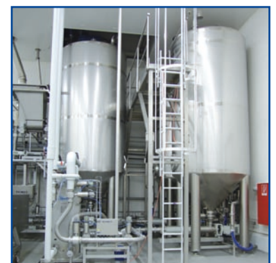
Wie das Knetersystem arbeitet auch die Vorteiganlage kontinuierlich.
