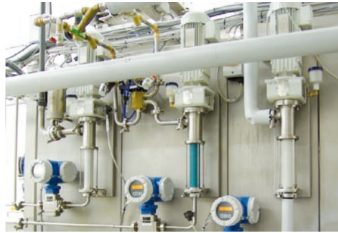
Schlüsseltechnologie des Knetsystems ist die exakte Verwiegung. Hier die Durchflussmesser für Flüssigkomponenten.
