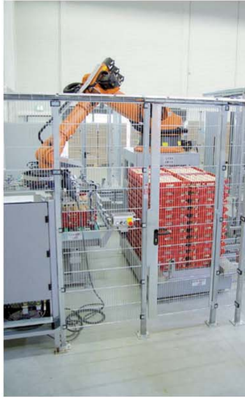
Korbhandling und Stapelung erfolgen vollautomatisch.
