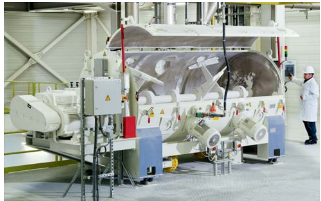
Horizontalmischer HUH 8000 zur Homogenisierung mit zwei Zerhackern
