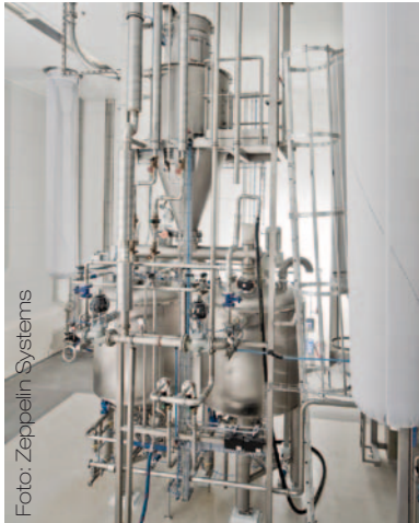
Bild links: Die Anlage für die in der Produktion eingesetzten Brüh- und Quellstücke lieferte auch Zeppelin Systems. Bild Mitte: Auch die Steuerung der Fermentationsprozesse erfolgt über das Batchmanagementsystem Prisma Web2. Bild rechts: Neben dem Netzwasser werden mehr und mehr Zutaten flüssig dosiert, wie hier Hefe und Salz.
