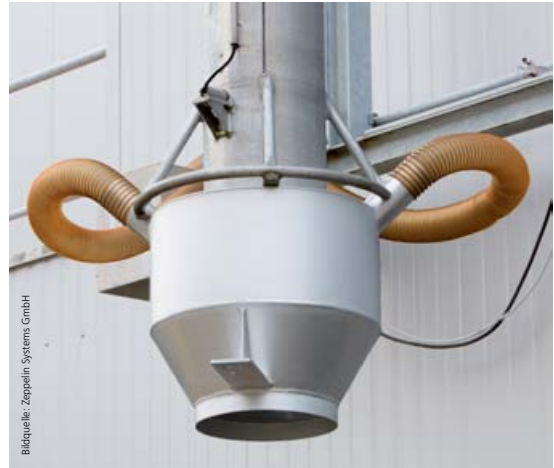
Im Sichter FVS wird das Granulat nur durch Schwerkraft beschleunigt, in einem Ringspalt dispergiert und durch einen Gasstrom gereinigt.
