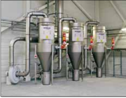
Filter werden nach ATEX-Richtlinien entsprechend ausgetauscht
