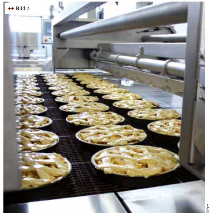
++ Bild 2 Die Apfelkuchen bleiben je nach Größe für 40 bis 65 Min. in einem der beiden gasbeheizten Heißluft-Durchlauföfen von Aasted. So kommt die Bäckerei auf eine Backfläche von insgesamt 124 m 2
